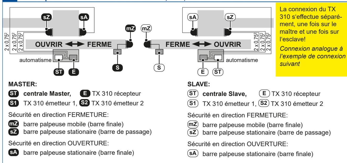
**Exemple d'utilisation 1: Barre palpeuse mobile sur le portail pour sécurité en direction de FERMETURE et barre palpeuse stationnaire sur le pillier pour sécurité en OUVERTURE / FERMETURE**
