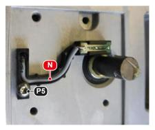
Maintenant faire conduire le câble de déverrouillage de secours (N) du déverrouillage moteur à travers le Passefils en caoutchouc dans l'ouverture du moteur (X) à l'intérieur du moteur et le brancher sur la centrale de commande (ST) comme indiqué.
