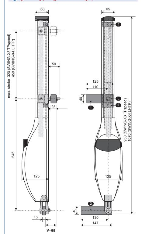
optional: torseitige Motorkonsole (schraub- und verstellbar)
