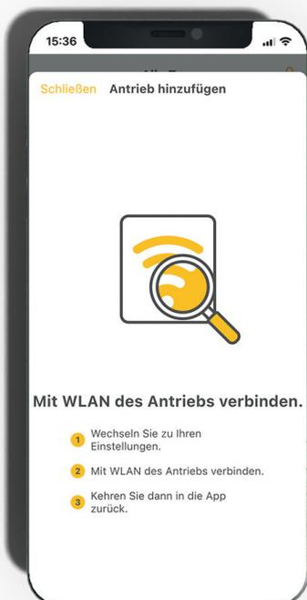
Nach dem Einstecken muss das Modul durch Scannen des QR-Codes oder mit der manuellen Eingabe des Passwortes mit dem TCON Wlans verbunden werden.
