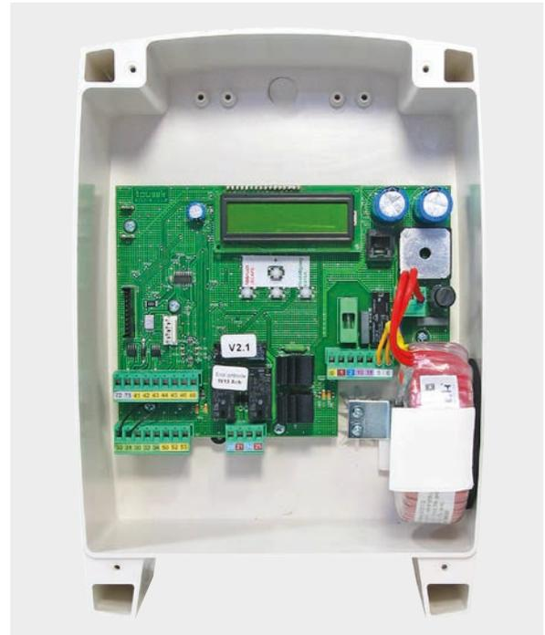
5. Die 3-polige Klemmleiste (**K1**), an der die roten Kabel angeklemmt sind, in den unten abgebildeten Steckplatz einsetzen.
