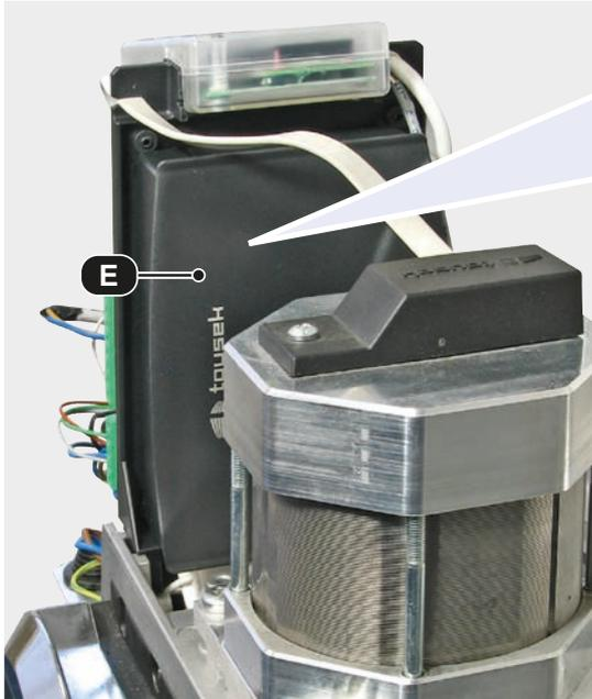
Der Empfänger (E) wird in Antriebssteuerungsnähe montiert - bei Antrieben mit integrierter Steuerung also am (im) Antrieb (z.B. im PULL T5, -T8, -T10 Antrieb: Montage des TX 310 Empfängers mittels Klettband - siehe Abbildung)
